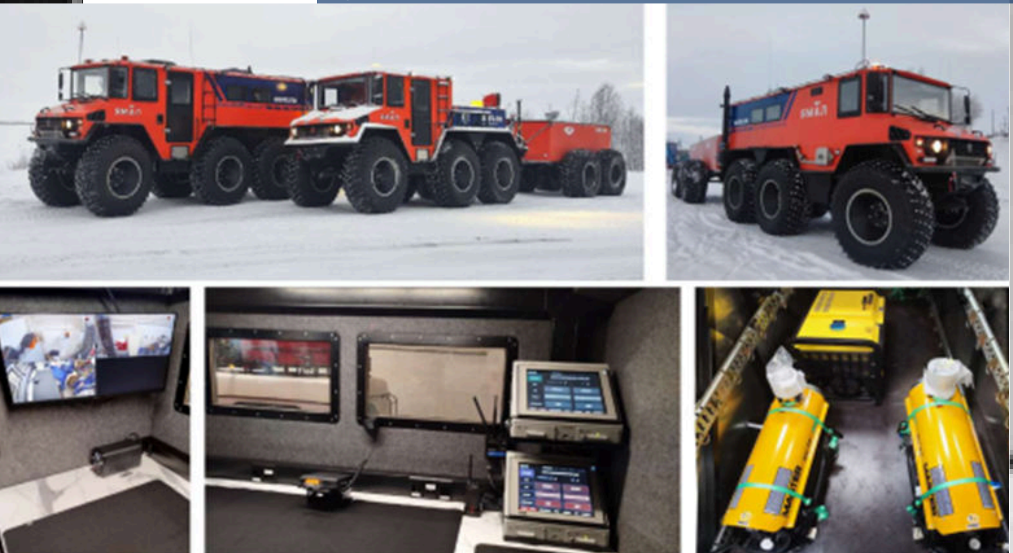
Figura B.7.2.: Locais de pouso móveis para sistemas de aeronaves não tripuladas
